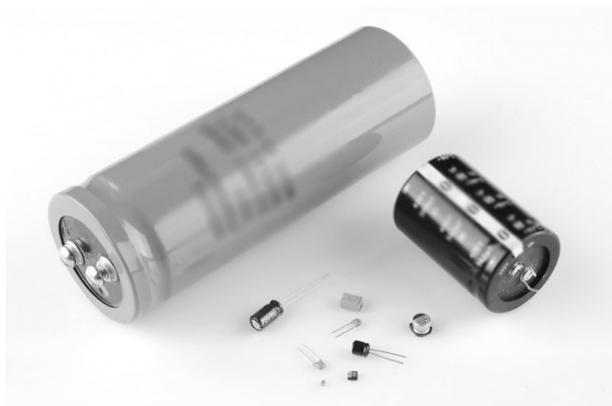
I condensatori sono racchiusi in cilindri di alluminio e sono composti da due piastre metalliche ed un materiale isolante chiamato dielettrico: le piastre metalliche sono posizionate molto vicine tra loro, in parallelo, ma il dielettrico assicura che non si tocchino.
